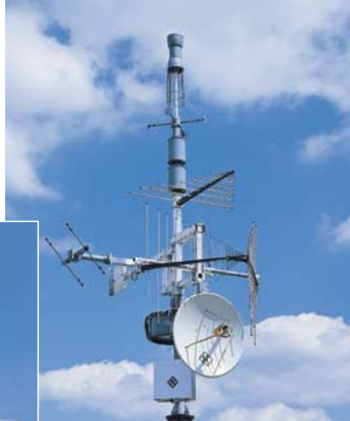
Антенны R&S AU900A5 (слева) и R&S AU900A4 (справа) покрывают диапазон частот от 10 кГц до 3 ГГц
