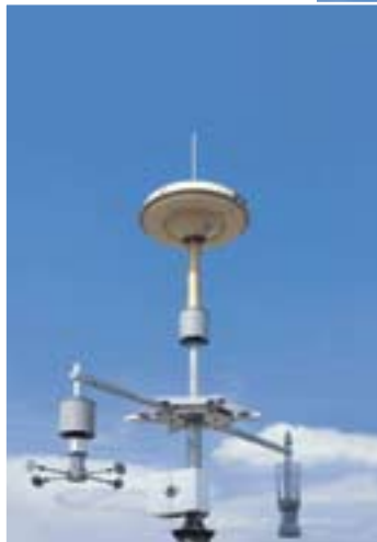
Антенны R&S AU900A5 (слева) и R&S AU900A4 (справа) покрывают диапазон частот от 10 кГц до 3 ГГц
